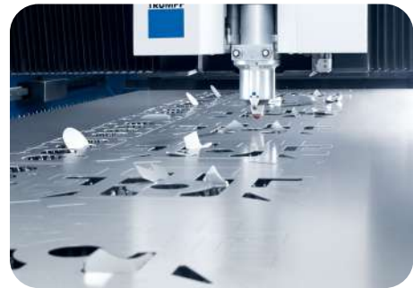
Laserschneiden Trumpf TruLaser 3030 bis 3.000x1.500 mm
