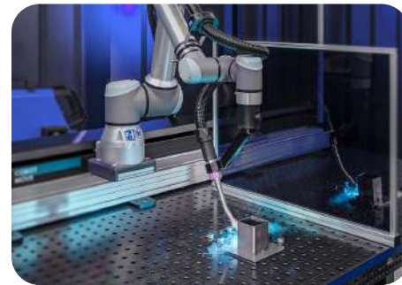
Roboterschweißen (MAG) Lorch Welding Cobot
