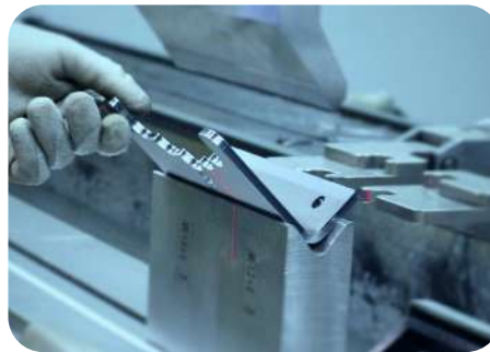
CNC-gesteuertes Abkanten LVD PPEB-EFL 320/51 Amada HFB 1253
